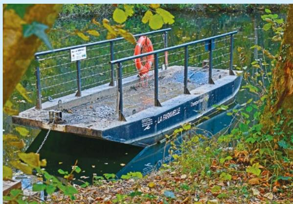
C'est simple ! La barque sécurisée par des rambardes est reliée aux deux rives par des chaînes installées à chacune de ses extrémités. Il suffit de tirer sur la chaîne placée sur le ponton pour faire venir le bac vers vous. Une fois installés (attention, pas plus de 6 passagers, 450 kg de charges, matériel compris), vous tirez à nouveau sur la chaîne placée au bout du bac pour atteindre tranquillement la berge opposée.
